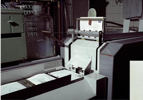
Automatische Öffnungsanlage 10/10 aus DDR-Produktion zum Öffnen wasserlöslich verklebter Briefe ohne Einlagen. Der Automat öffnete 300-500 Briefe gleichzeitig.
