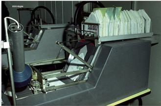
Automatische Schließanlage 3/81
